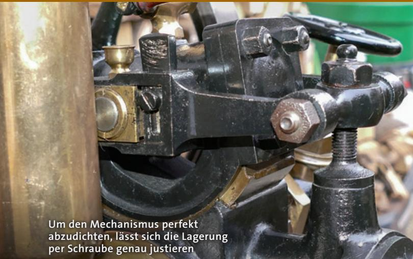
Um den Mechanismus perfekt abzdichten, lässt sich die Lagerung per Schraube genau justieren
