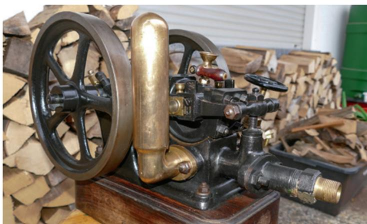
Der angeflanschte Messingzylinder ist ein sogenannter „Windkessel“. Der nimmt die während der Umsteuerung entstehenden Druckspitzen auf
