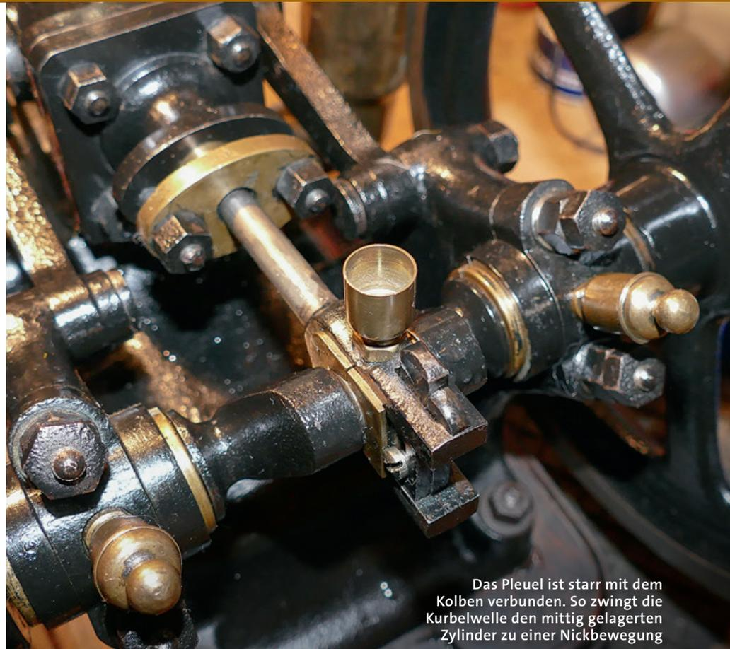
Das Pleuel ist starr mit dem Kolben verbunden. So zwingt die Kurbelwelle den mittig gelagerten Zylinder zu einer Nickbewegung
