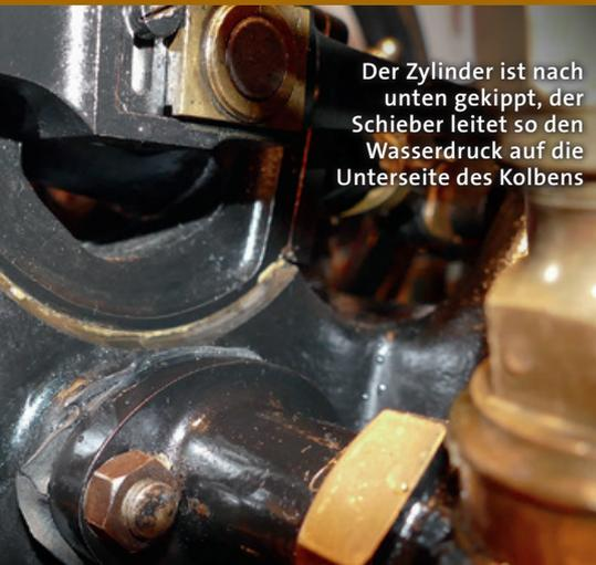
Der Zylinder ist nach unten gekippt, der Schieber leitet so den Wasserdruck auf die Unterseite des Kolbens
